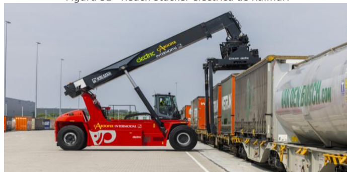
Figura 31 - Reach Stacker eléctrica de Kalmar.
