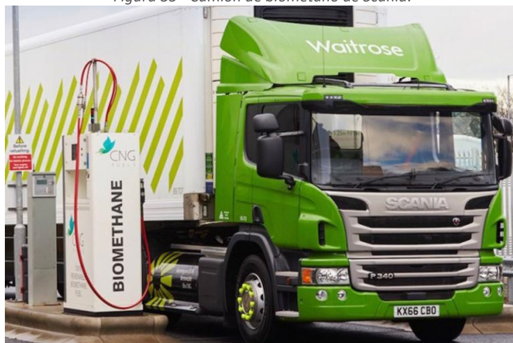
Figura 35 - Camión de biometano de Scania.
