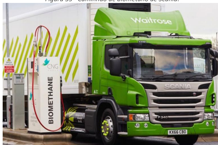
Figura 35 - Caminhão de biometano de Scania.
