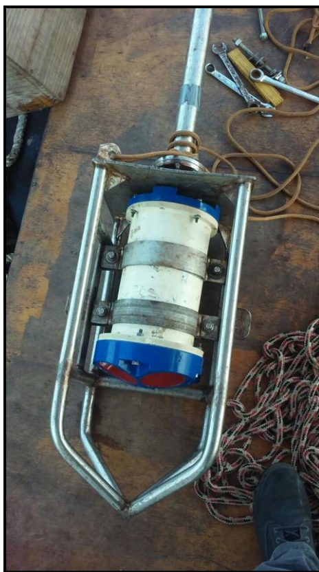
Figura 4: Estrutura utilizada para estabilização do ADCP.
