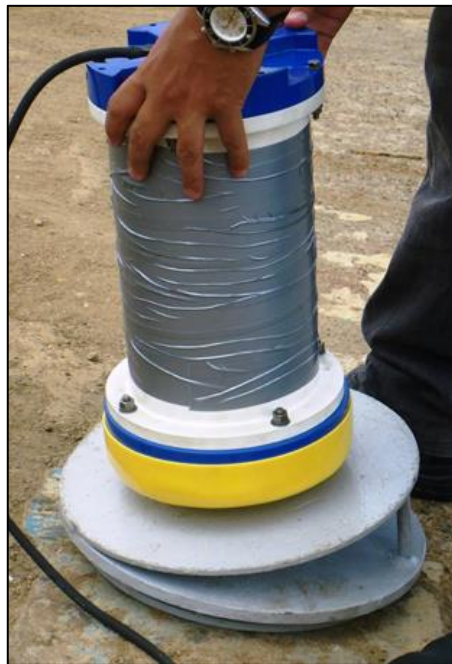
Figura 5: Calibração de campo realizada com os ADCPs para compensar as influências magnéticas locais.
