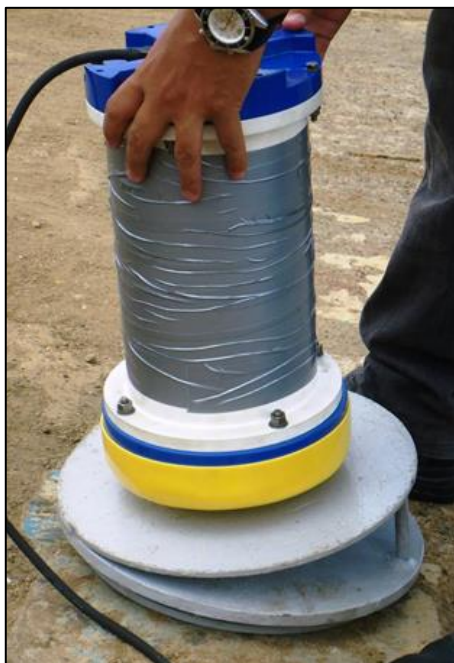
Figura 4: Calibração de campo realizada com os ADCPs para compensar as influências magnéticas locais.
