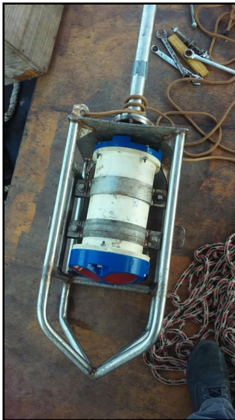
Figura 3: Estrutura utilizada para estabilização do ADCP.
