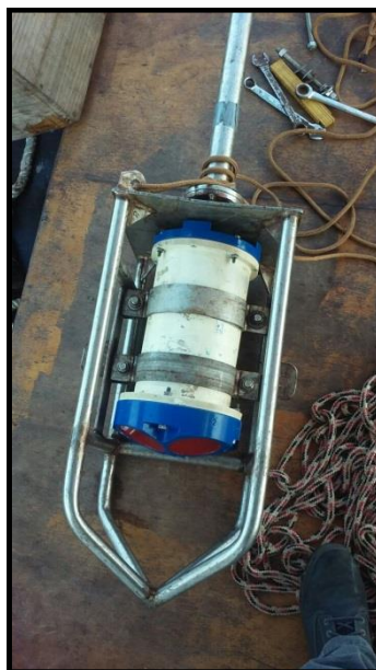
Figura 3: Estrutura utilizada para estabilização do ADCP.
