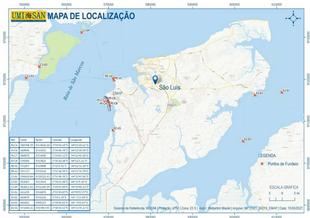
Figura 2: Localização dos pontos de levantamento com ADCP. Em cada ponto foram realizados levantamentos correntométricos durante momentos de enchente e vazante da maré, tanto em período de sizígia quanto de quadratura.
