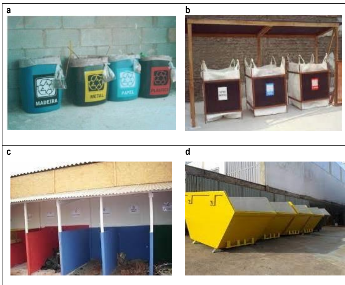
Figura 28: Modelos de dispositivos de armazenamento para acondicionamento de resíduos de construção civil (a-bombonas; b- bag; c- baias; d- caçambas estacionárias).
