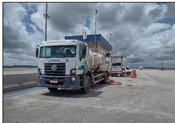
Figura 12: Empresa Maxtec realizando a retirada de efluentes sanitários, na área dos Berços, no Porto do Itaqui.
