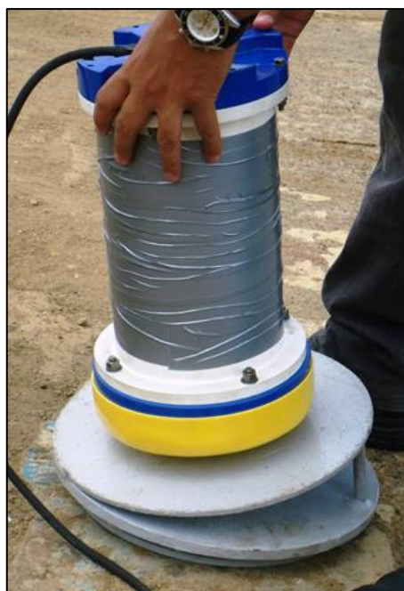
Figura 3: Calibração de campo realizada com o ADCP para compensar influências magnéticas.
