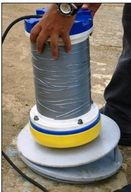
Figura 3: Calibração da bússola interna do ADCP para compensar influências magnéticas.
