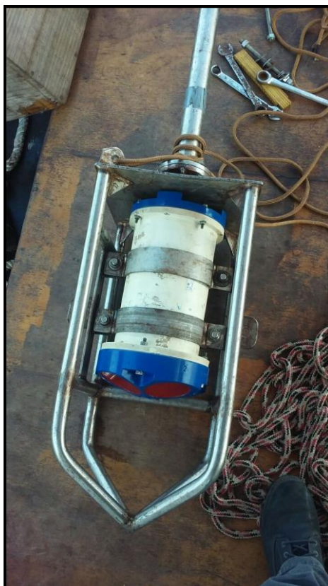
Figura 2: Estrutura utilizada para estabilização do ADCP.
