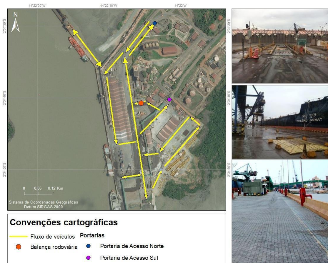
Figura 69 – Fluxo nas vias internas do cais do Porto do Itaqui e tipos de pavimentos utilizados Fonte: Google Earth (2019) e imagens obtidas durante visita técnica ou fornecidas pela EMAP. Elaboração própria (2019)
