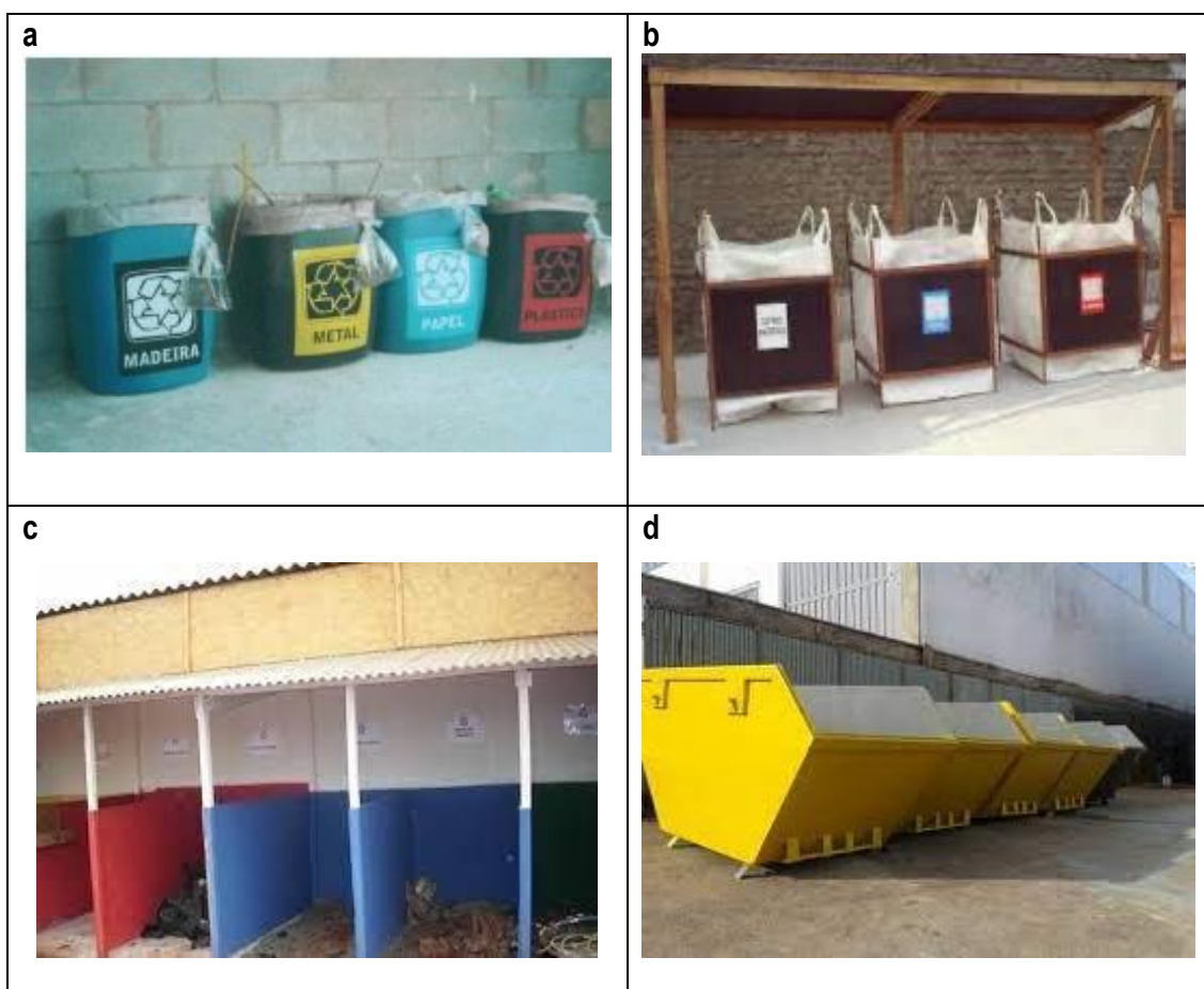
Figura 30 – Modelos de dispositivos de armazenamento para acondicionamento de resíduos de construção civil ( a -bombonas; b - bag; c - baías; d - caçambas estacionárias).
