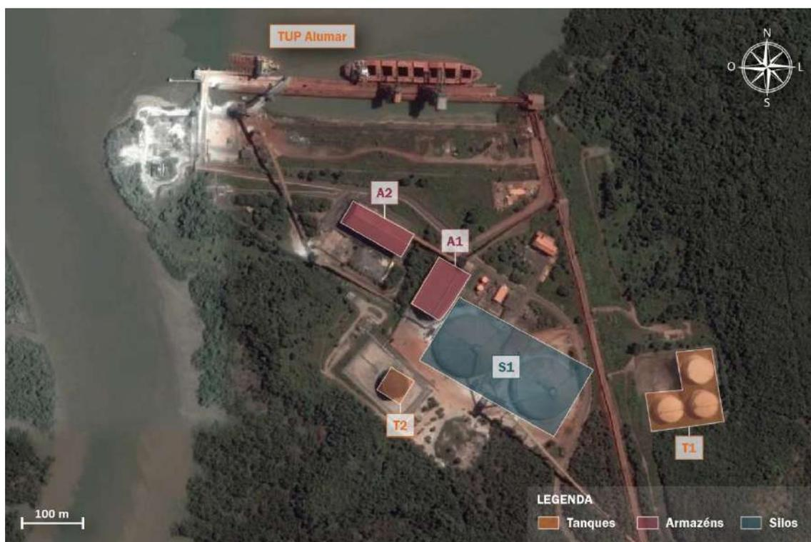
Figura 11 – Estruturas de armazenagem na área do TUP Alumar
