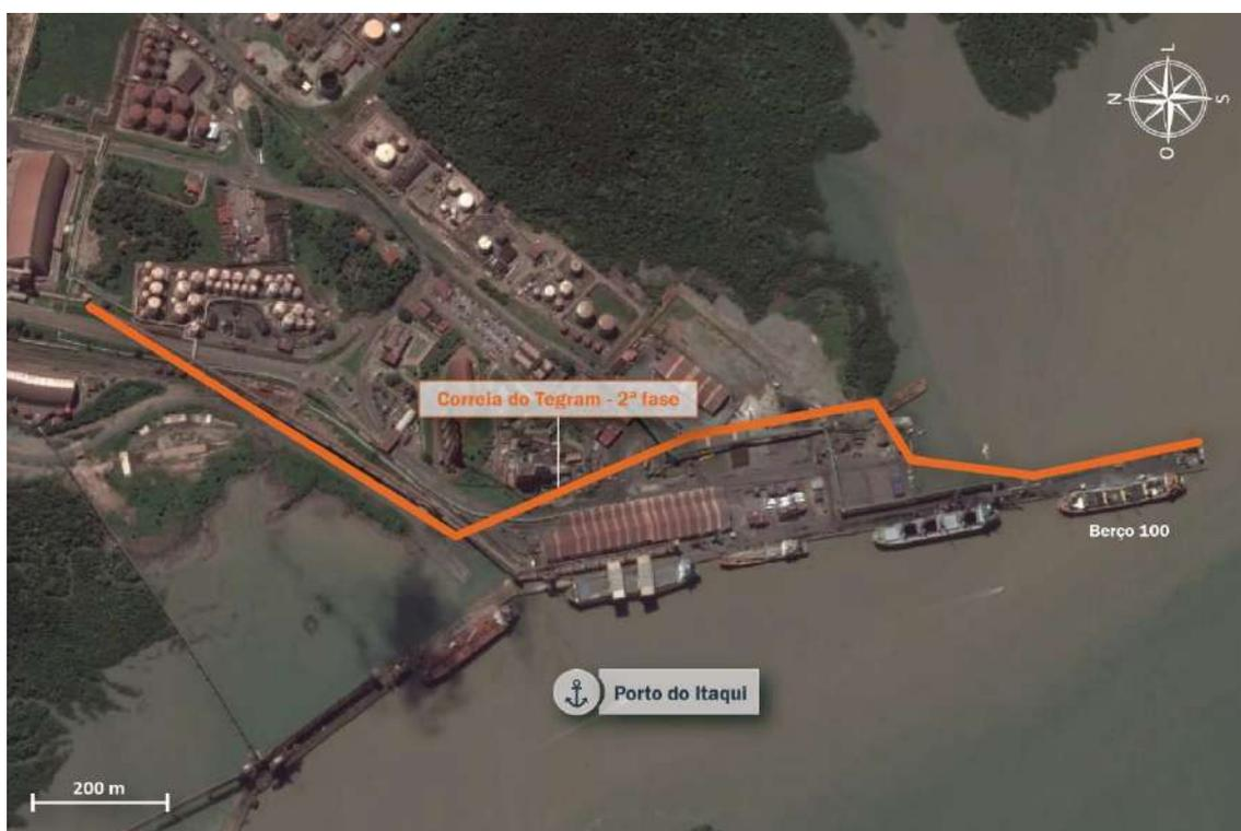
Figura 18 – Nova configuração da esteira transportadora do Tegram
